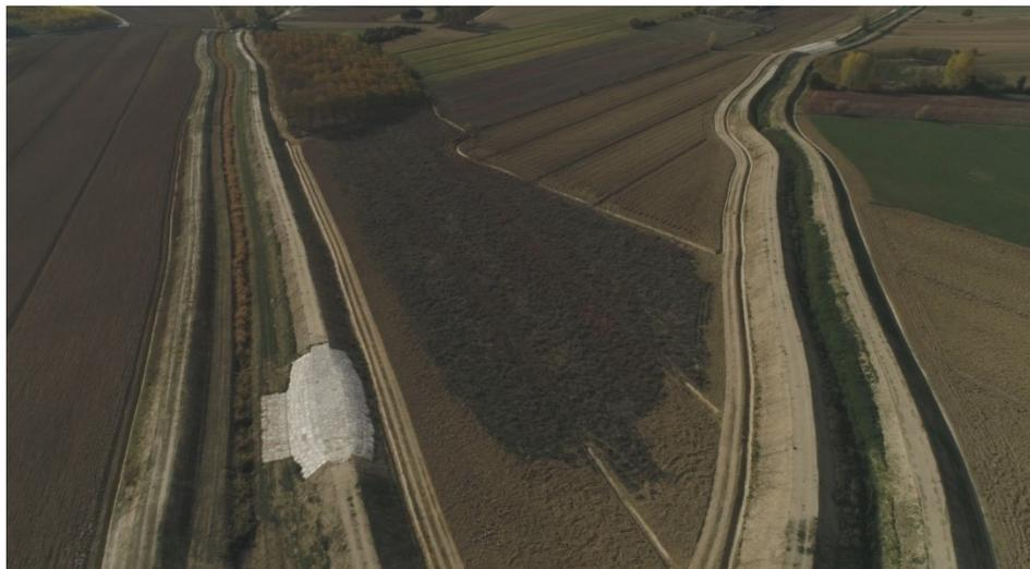
Figura 1 – cassa d'espansione realizzata in Località Salcheto, in basso a sinistra lo sfioratore di sicurezza sull'argine del torrente. Salcheto, in alto a destra l'opera di presa sull'argine del torrente. Ciarliana.
